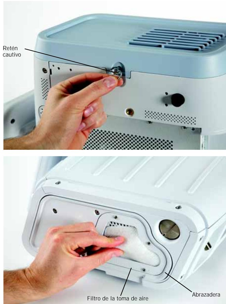
*Figura 10-1: Sustitución del filtro de la toma de aire*
