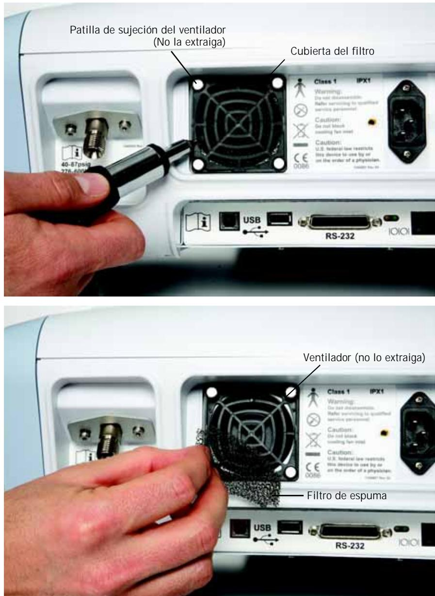
Figura 10-2: Sustitución del filtro del ventilador de refrigeración
